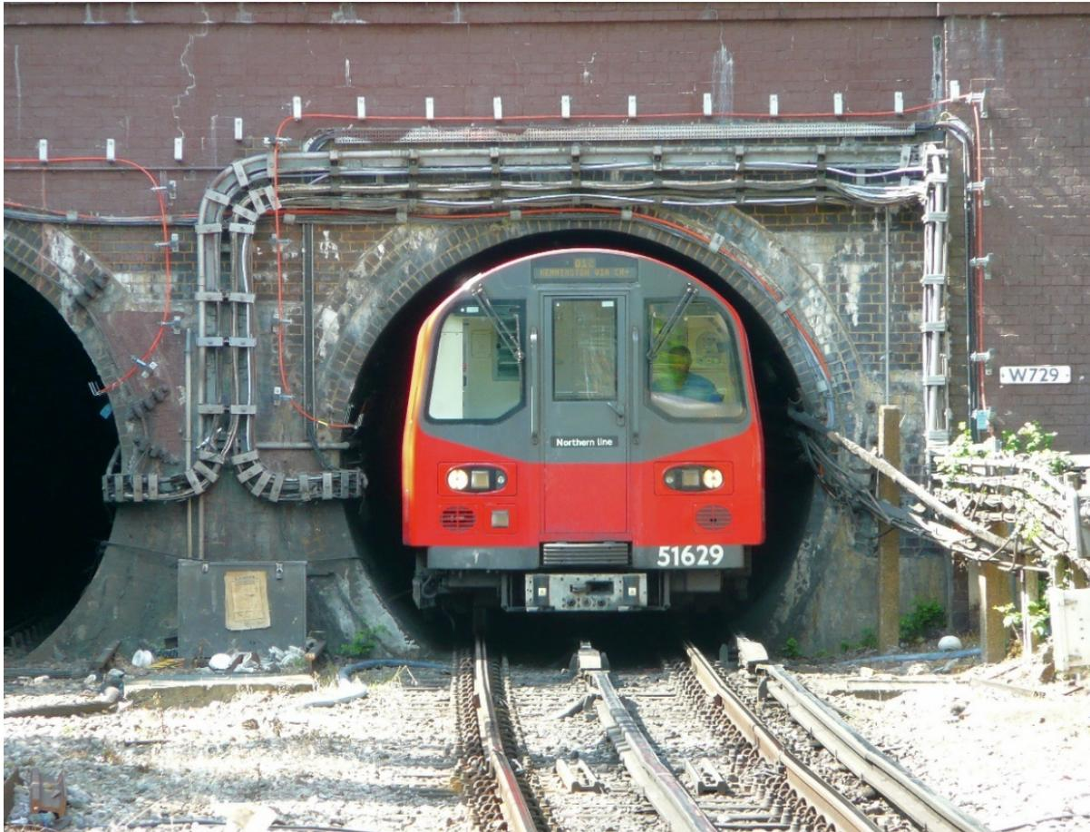
**Abbildung 7: Offenliegende Mittelschiene**
